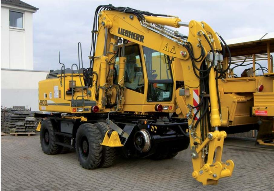
Zweiwege-Bagger werden für viele unterschiedliche Arbeiten auf und neben den Gleisen genutzt. Sie sind mit Rücksichtüberwachung, Höhen-, Schwenk- und Hubbegrenzer ausgerüstet. Weiterhin sind alle Zweiwege-Bagger mit allen notwendigen Ausrüstungen, wie zum Beispiel Greifer, Magnet usw. ausgestattet.
